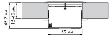
Монтаж в столешницу до 15 мм с использованием демпферного кольца
