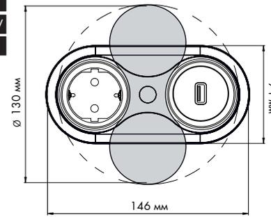
Монтаж в столешницу от 15 до 40 мм
